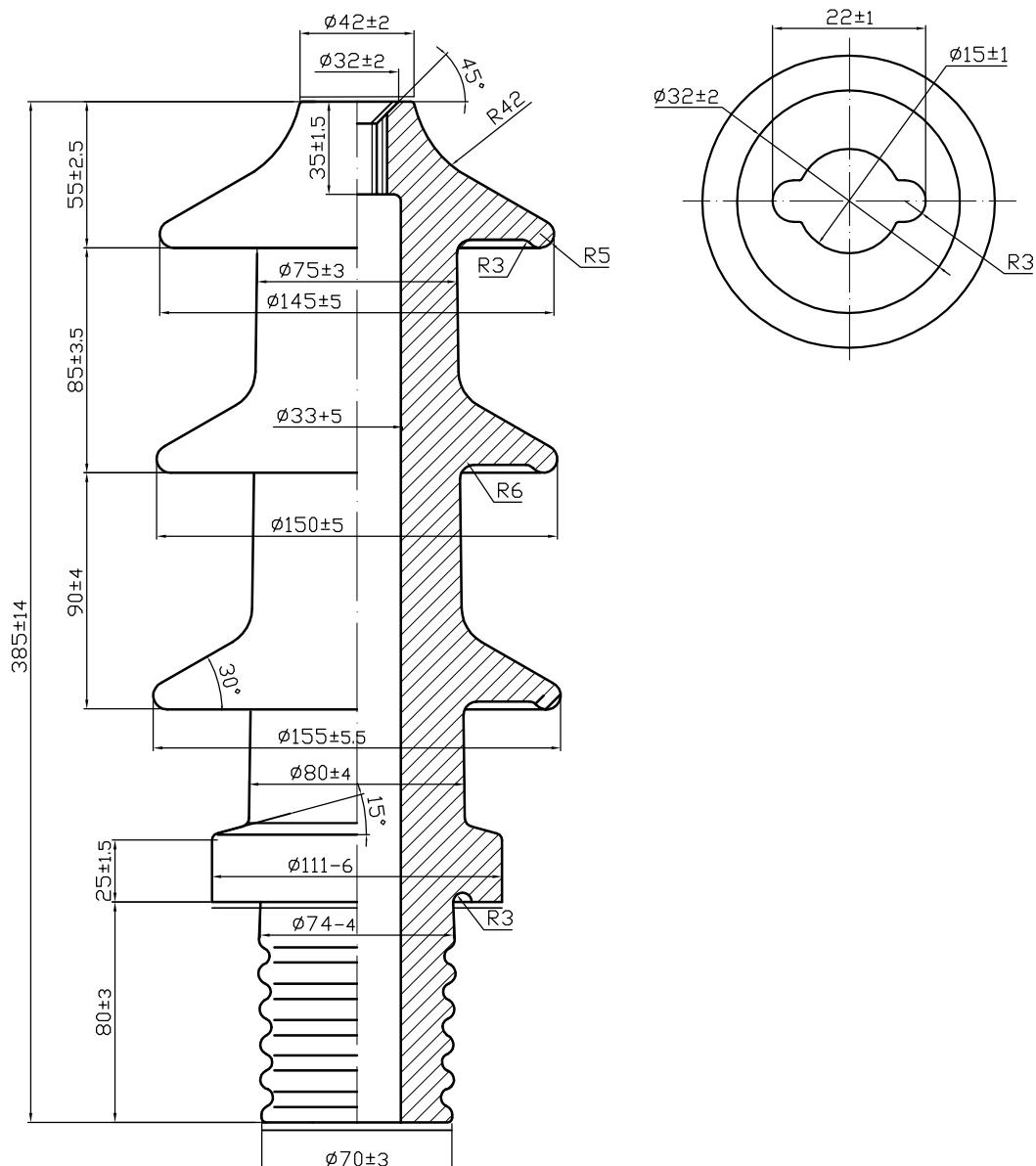
**SÚ BIỂN ÁP 20KV 250A****HIGVOLTAGE BUSHING INSULATOR 20KV 250A**
