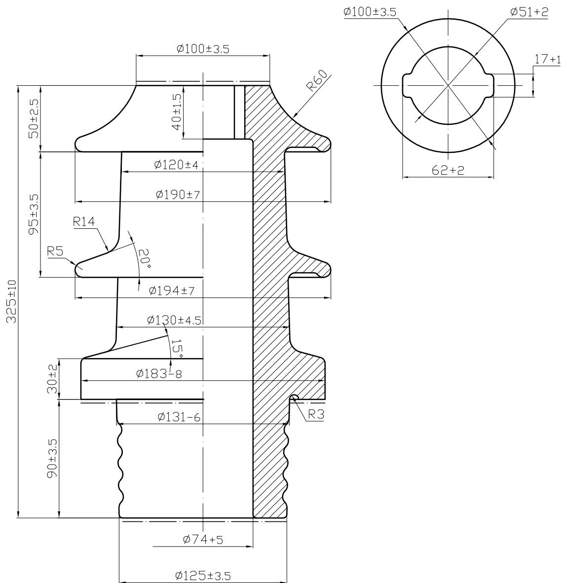
**SÚ BIẾN ÁP 10KV 3150A
